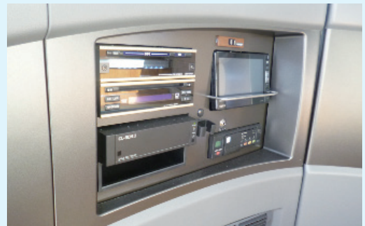
デジタルタコグラフ設置例（観光バス）
